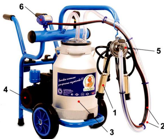
8.13-rasm. Ko'chuvchan sut sog'ish apparati 1 - sut sog'ish stakanlari; 2 - havo va kanalizatsiya kanallari; 3 - sutni yig'ish uchun idish; 4 - nasos; 5 - kollektor (sutni to'rtta so'rg'ich idishidan yig'ish uchun ishlatiladi); 6 - pulsator.
