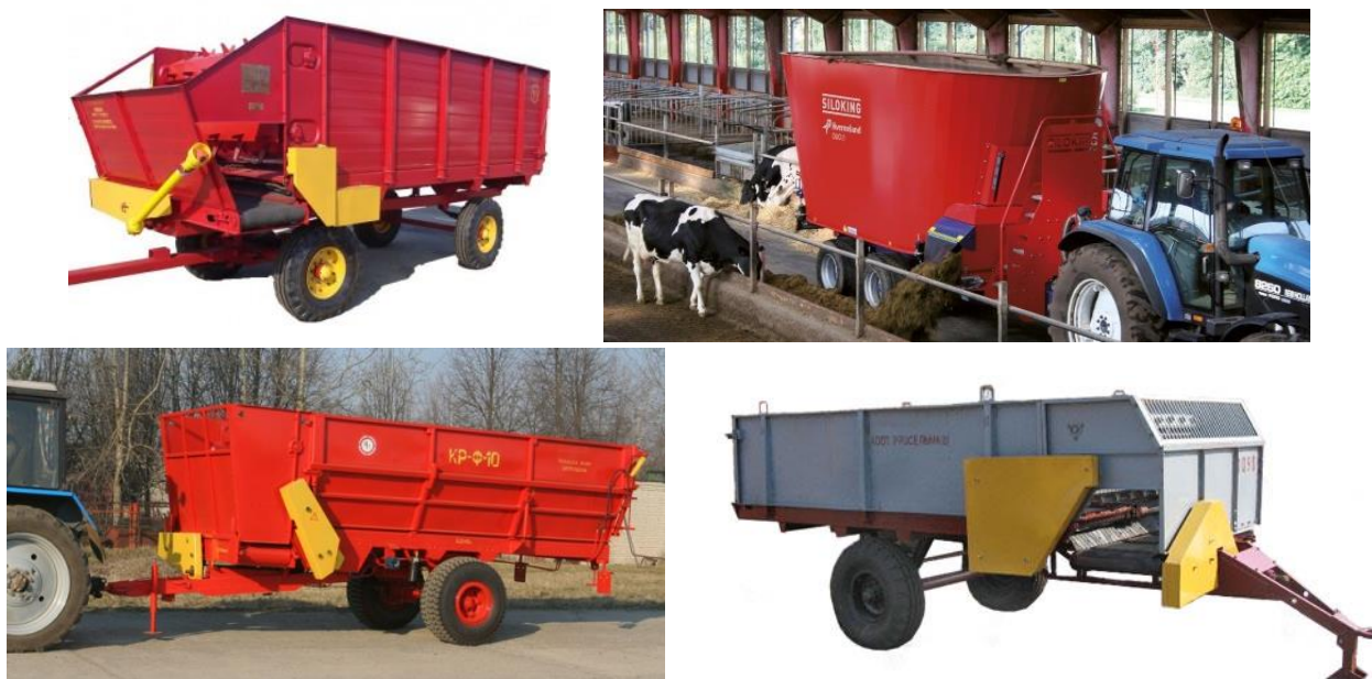
8.14-rasm. Mexanizatsiyalashtirilgan ozuqa tarqatgichlar
