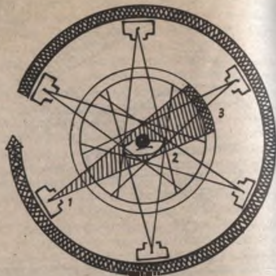
19-расм. Айланувчи детекторли майдонга эга бўлган компьютерли томографияда ёйилувчи нурлар билан ёритиш принципи. 1) рентген трубкаси; 2) объект; 3) 520 та детектордан иборат детекторли майдон.
