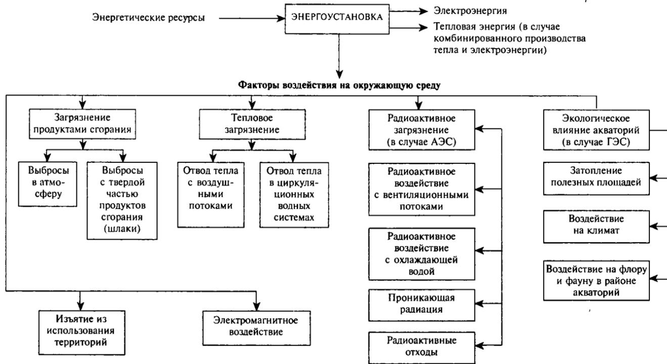
Рис. 14. Основные факторы воздействия электроэнергетики на окружающую среду (по В. Б. Козлову, 1982)
