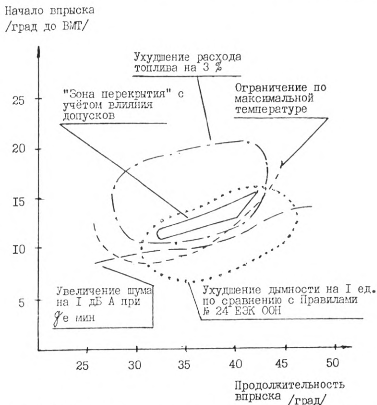
Рис.4.1. График регулировочных параметров быстроходного вихрекамерного дизеля с турбонаддувом
