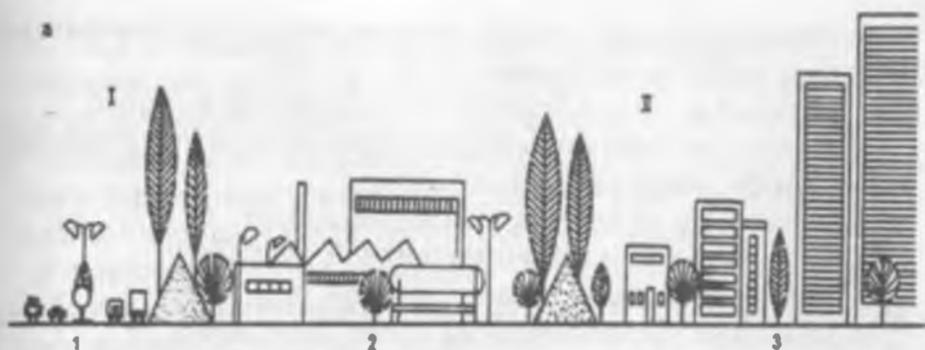
Рис. 25. Схема зонирования примагистральной территории (Франция): I, II – пояса защиты от шума, включающие земляной кавальер; 1 – источник шума; 2 – безвредные промышленные предприятия и учреждения, обслуживающие население; 3 – жилая застройка, зонированная по этажности.
