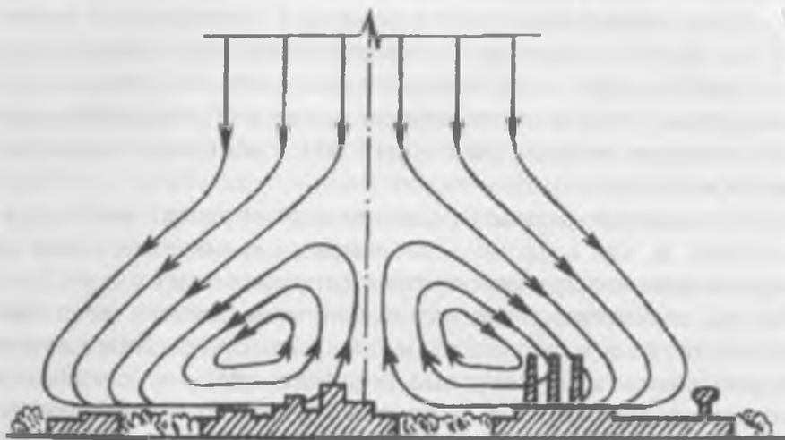
*Рис. 8. Образование «острова тепла».
