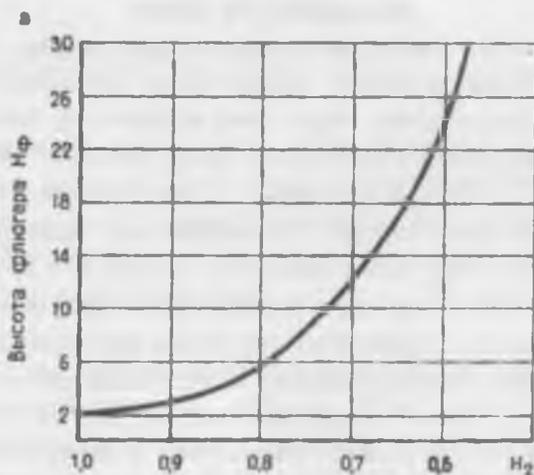
Рис. 10. Методы расчета аэрации в застройке (по К.И. Семашко). Коэффициент перевода  $K = (H_2 / H_\phi) * 1/5$
