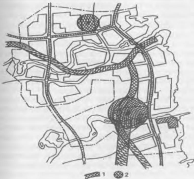
Рис. 13. Оценка электромагнитного поля: 1- линии электропередачи; 2- радиостанции, телестанции, радар.
