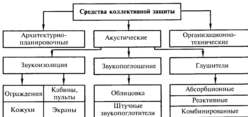
Рис. 2.11. Схема коллективной защиты от шума
