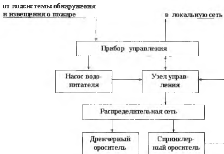
Рис. 20. Обобщенная структурная схема подсистемы водяного пожаротушения имеет следующий вид:
