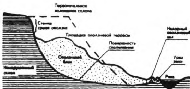
Рис. 2.15. Продольный разрез оползня
