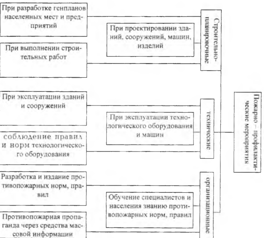
Рис. 8. Принципиальная схема осуществления пожарно-профилактических мероприятий
