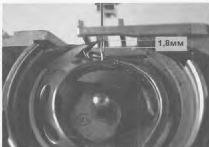
85 - rasm. Igna bilan moki orasidagi tirqishni o'rnatish
