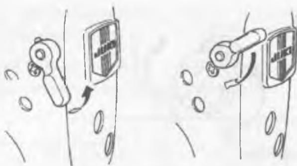
20-rasm Tepkini qo'l bilan ko'tarish
