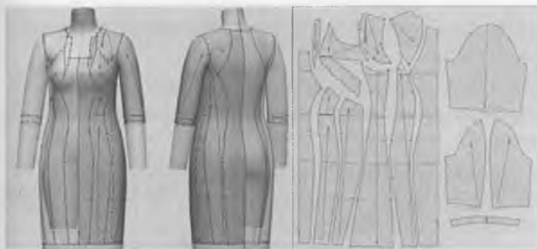
109-rasm. Ayollar ko'ylagi andazalarini ishlab chiqish
