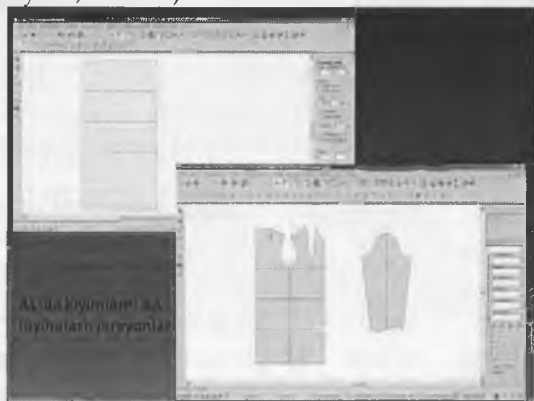
4-rasm. Kiyimni bazaviy konstruksiyasini qurish
