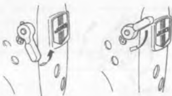
20-rasm Tepkini qo'l bilan ko'tarish
