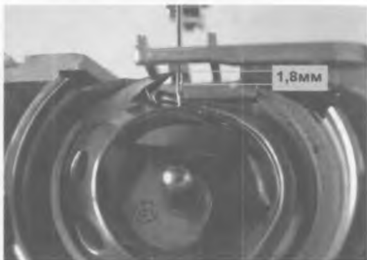
85 - rasm. Igna bilan moki orasidagi tirqishni o'rnatish
