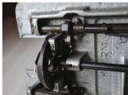
3.5-расм. Моки шпулқасини автоматик тўлдириш мосламасини ўрнатиш жараёни
