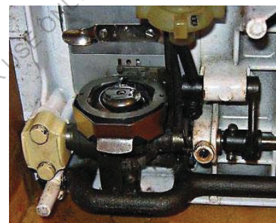
3.5-расм. Моки шпулқасини автоматик тўлдириш мосламасини ўрнатиш жараёни
