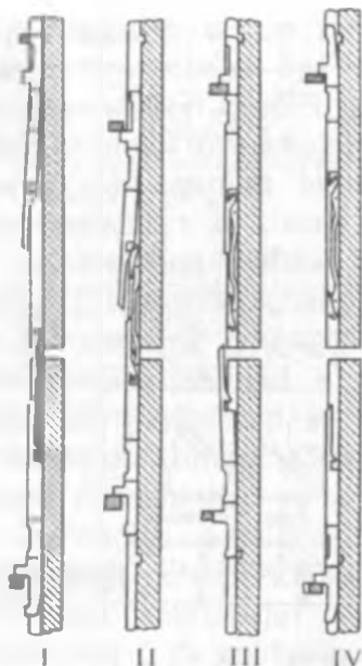
112-rasm. Ignalarni pastki silindrdan yuqorigisiga o'tkazish sxemasi.
