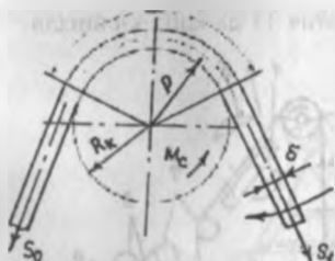
7-расм. Материал ва ўлчаш органларининг ўзаро таъсири
