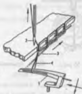
57-расм. Чапиштиригич ёрдамида баҳя ҳосил бўлиши: 1-чапиштиригич, 2-игна, 3-чапиштиригич ипи, 4-игна ипи, 5-газлама
