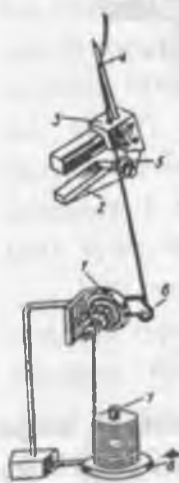
85- расм. 1622 русумли тикув машина- 86-расм. Устки чалиштиргич механизми сиди остки ип тақилиши
