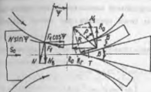
41 - расм. Қийиш жараёнида материалга таъсир қилувчи кучлар схемаси
