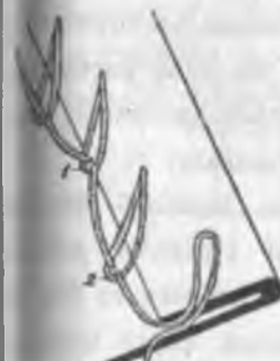
96-расм. Игнанинг бир гал санчилишидан кейин материални бурттириб юритилган бир илдан иккинчи санчилишидан ба'яли қисмни сатор
