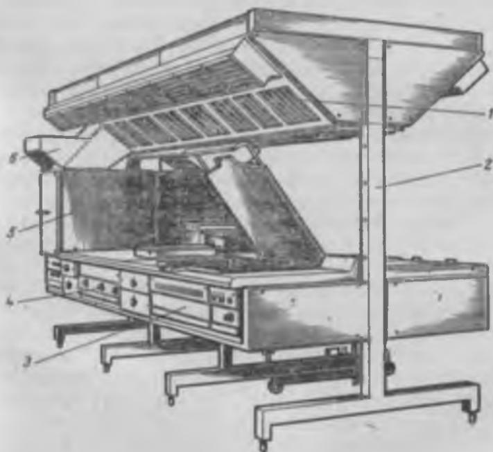
Рис. 4.1. Комплект электротеплового секционного модулированного оборудования, установленного на единой ферме
