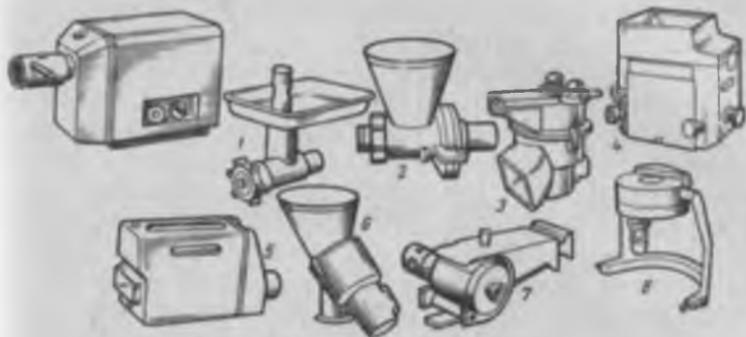
Рис. 3.1. Универсальный привод П-II со сменными механизмами
