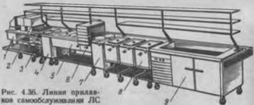
Рис. 4.36. Линия прилавков самообслуживания ЛС
