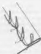
Рис. 59. Строчка однострочного цепного потайного переплетения с выдавливанием материала через один прокол иглы
