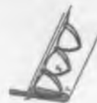
Рис. 56. Строчка однониточного цепного потайного переплетения
