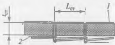
Рис. 47. Двухниточный цепной стежок типа 401
