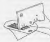
Рис. 39. Схема установки высоты рейки по калибрам для швейных машин конструктивно-унифицированных рядов 31 и 131
