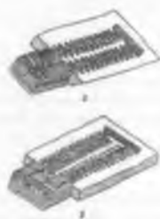
Рис. 76. Внешний вид петель: а — гладьевое переплетение; б — бисерное переплетение
