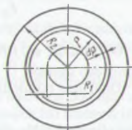
8.2- rasm. Joylamaning elementar halqaviy qatlamli kesim sxemasi.
