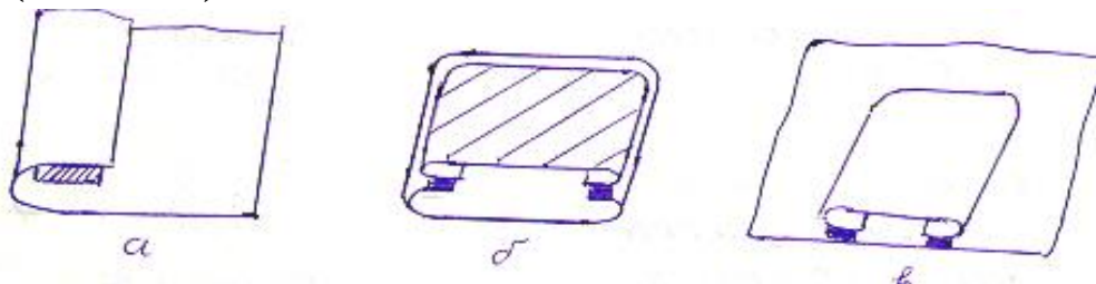
6.3-rasm. Detallar chetlarini yelim yordamida ulash.
