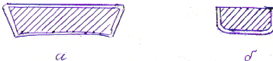
6.2-rasm. Detallarga butun yuzasi bo'yicha qotirma qo'yish.
