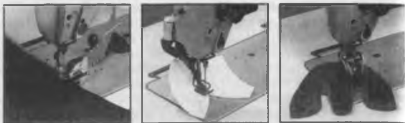
30-rasm. Mashinada turli ishlarni bajarishga mo'ljallangan maxsus moslamalar.
