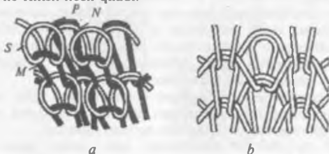
113-rasm. Polufang va fang to'qimalari tuzilishi.
