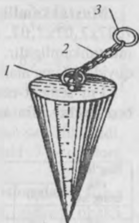
3-rasm. Qorishma qo'zg'aluvchanligini aniqlash etalon konusi: 1—konus; 2—zanjir; 3—halqacha.
