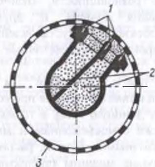
Рис. 3.18. Отсасывающий вал камерного типа:
