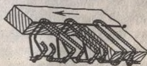
76-расм. Икки ипли занжирсимон йурмаш бахяқатори.
