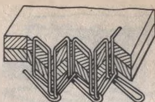
70-расм. Бир ипли синиқ занжирсимон очик бахяқатори.
