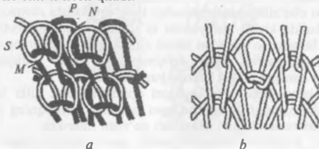
113-rasm. Polufang va fang to'qimalari tuzilishi.
