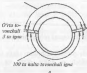
119-rasm. Avtomat silindrida igna va turtkichlarni joylashtirish sxemasi.
