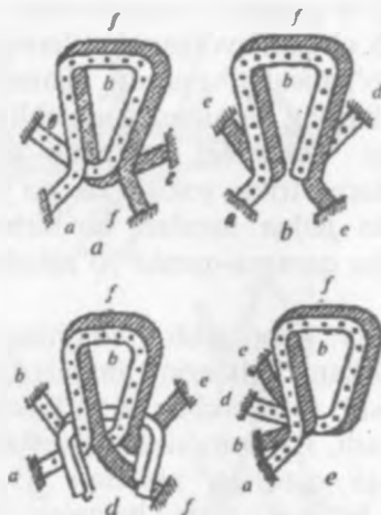
70-rasm. Yopqichli tanda trikotaj to'qimasi halqa tuzilishi.
