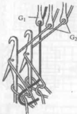
105-rasm. Arqoq trikotajini to'qishda arqoq ipini qo'yish.
