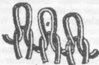
71-rasm. Almashinuvchan yopqichli to'qima tuzilishi.
