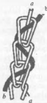
103-rasm. Arqoqli sepochnka to'qimasi tuzilishi.
