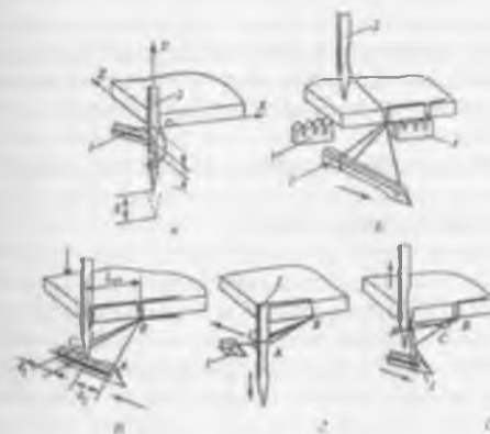
Рис. 49. Схемы образования двухниточного цепного стежка
