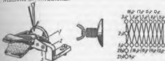
Рис. 74. Обвивка стойки пуговицы на машине 59—А кл.
