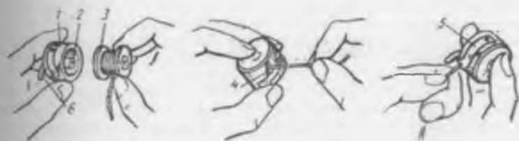
Рис. 67. Приемы заправки шпульки в шпульный колпачок
