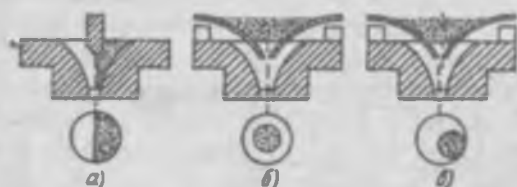
2.15-расм. Бикомпонентли ипларнинг кесими бўйича полимерларнинг жойланиши:
