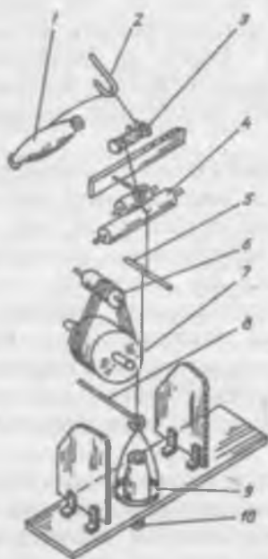
1.12-расм. Тортиб — чўзиш машинасида ипни чўзиш схемаси:
