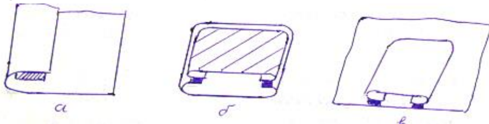
8.4-rasm. Detallar chetlarini yelim yordamida ulash.
