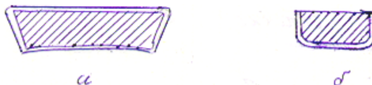
8.3-rasm. Detallarga butun yuzasi bo'yicha qotirma qo'yish.
