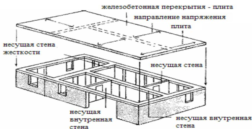
**Рис. 2.16. Железобетонные перекрытия.**
