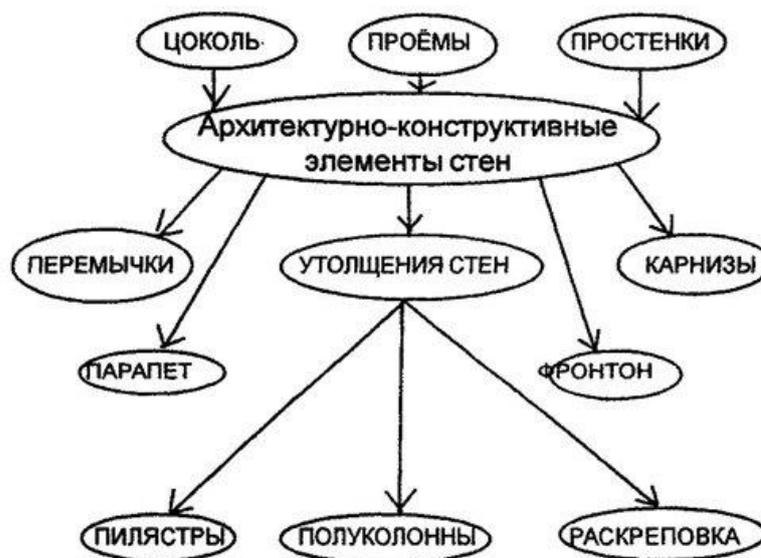
Рис.2.7. Кластер-схема архитектурно-конструктивных элементов стен.
