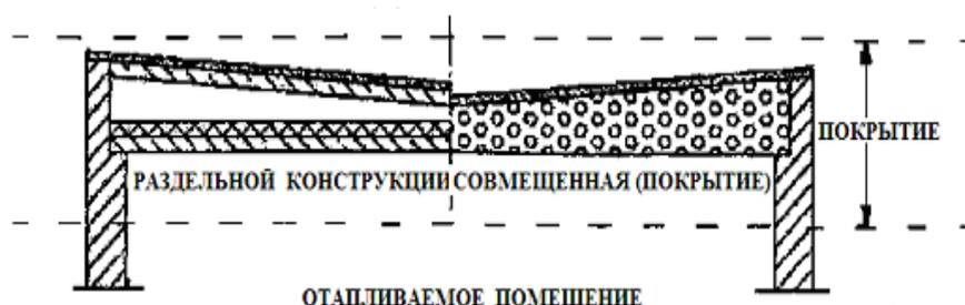
Рис.2.25. Бесчердачная крыша.
