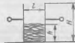
Рис. 8.7. Датчик массы волокнистого продукта
