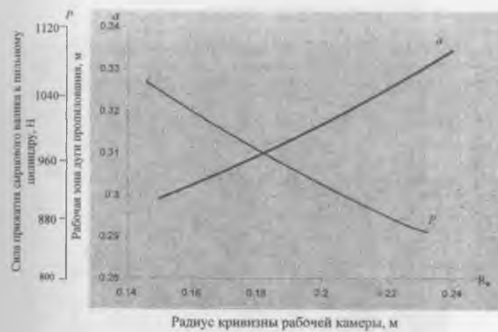
Рис. 2.4. Зависимость силы прижатия сырцового валика к тильному цилиндру в рабочей зоне дуги пропилования от радиуса кривизны рабочей камеры.
