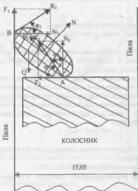
Рис. 4. 10. Движение семян в междутильном пространстве
