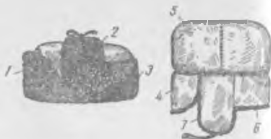
Рис. 32. Детали шапки-ушанки: 1 — колпак; 2 — наушники; 3 — козырек; 4 — назатыльник; 5 — подлицевая часть козырька; 6 — подлицевая часть назатыльника; 7 — подлицевая часть наушников
