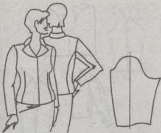
Рис. 1.16. Пример конструктивного решения одношовного втачного рукава для изделия с рельефом на спинке
