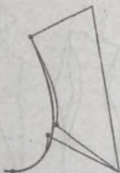
Рис. 2.11. Оформление линии проймы трикотажного изделия при переводе раствора вытачки
