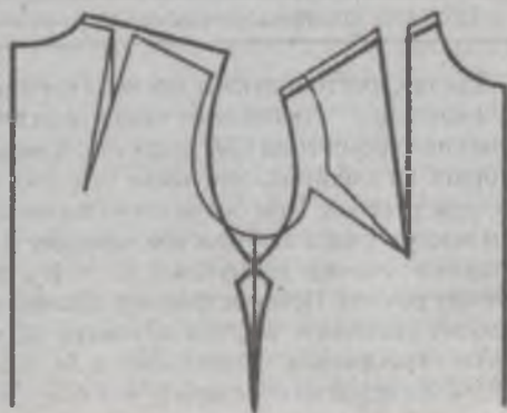
Рис. 2.42. Модификация БО в конструкцию изделия уплощенной формы с углубленной проймой
