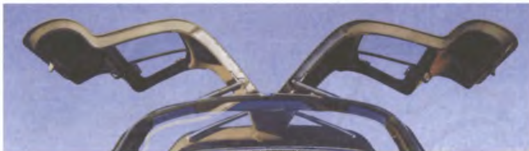
Автомобиль Mercedes-Benz 300 SL (1954). Откидывающиеся вверх двери типа «крыло чайки» по патенту Г. Триппеля
