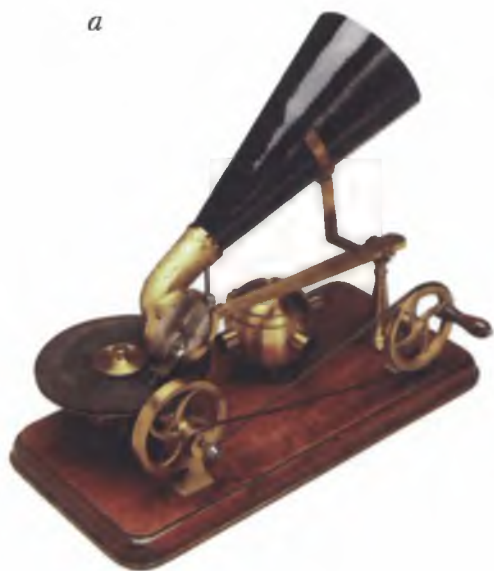
Граммофон Э. Берлинера, США, 1891 ( а ) и модель начала XX века ( б )
