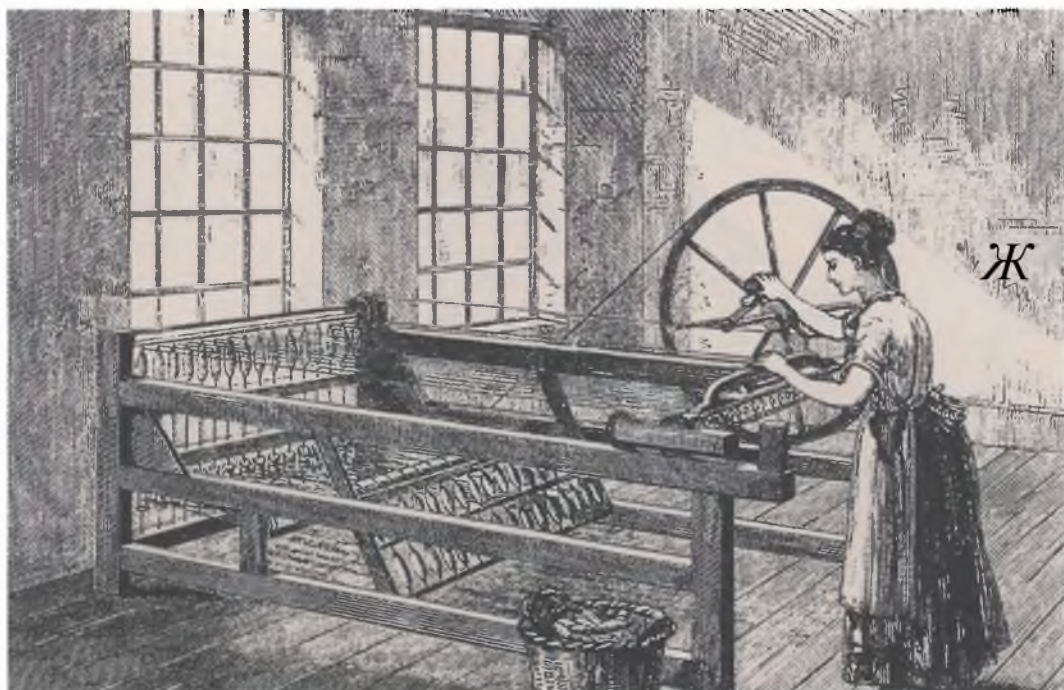
Прядильная машина «Дженни» английского ткача Джеймса Харгривса (1765), позволявшая работнику накручивать 8 веретен
