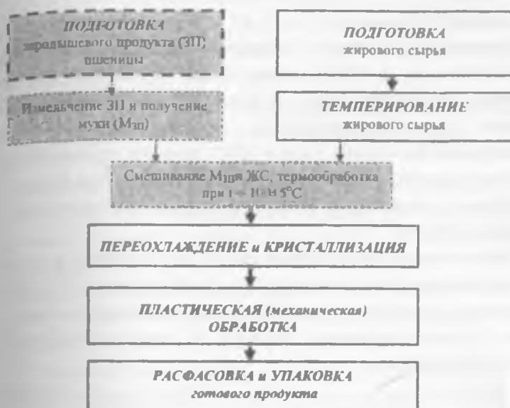
Рис. 3.8. Принципиальная схема интегрирования технологии переработки безводного жирового и растительного сырья для получения РЖС для мучных продуктов
