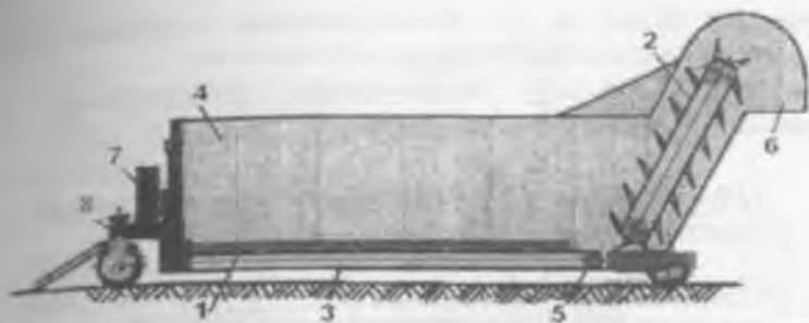
24-расм. ХПП русумли қабул қилиш-узатиш ва ПЛА русумли қабул қилиш - узатиш қурилмаларининг умумий қурилиши. 1- ролланг; 2- элеватор; 3- тасма; 4- борт; 5-Етакловчи барабан; 6-Нов; 7- электр щити; 8-Асос (станина)
