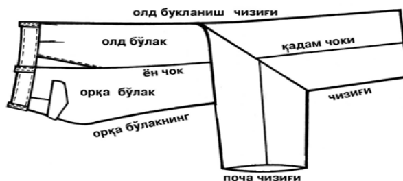
15.2 - расм. Текисликдаги типавий шим конструкциясининг ташқи кўриниши
