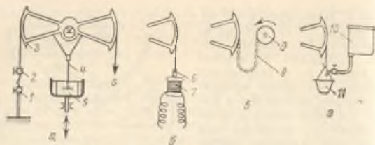
Рис. V.7. Схемы разрывной машины весового типа (а) и различных нагрузочных устройств (б, в, г)
