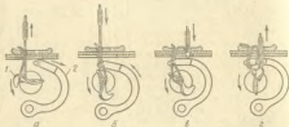
Рис. 1.114. Схема образования строчки на машине-полуавтомате 1095 кл.
