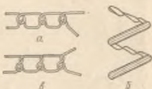
Рис. 1.54. Переплетение ниток челночных стежков с узлом и изменение крутки ниток в зигзагообразной строчке
