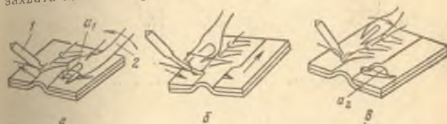
Рис. 1.36. Процесс образования стежка односторонней потайной строчки
