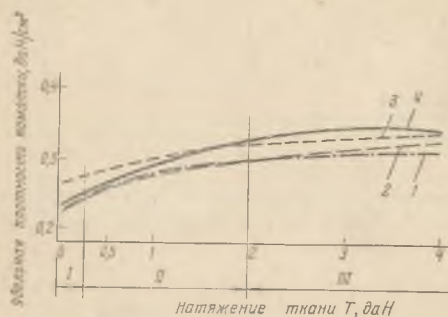
Рис. III.28. Зависимость удельной плотности намотки ткани (дроп) в рулон от натяжения: 1 — арт. 4604; 2 — арт. 46403; 3 — арт. 4636
