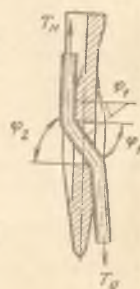
Рис. 1.44. Общий и рабочий ход иглы
