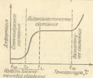
Рис. 1.138. Термодинамическая кривая монокристаллического полимера
