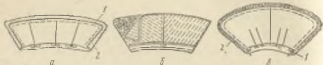
Рис. 11.52. Соединение мехового воротника с нижним воротником
