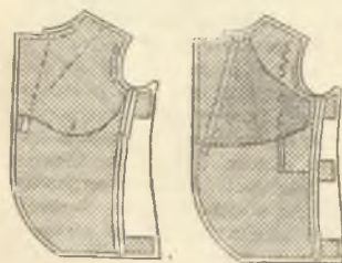
Рис. 11.3. Дублирование деталей многослойными прокладками
