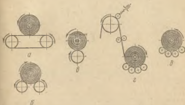
Рис. 111.31. Схемы устройств для разматки рулонов ткани
