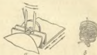
Рис. 1.115. Схема обивки ножки пуговицы на машине-полуавтомате 59 А кл.
