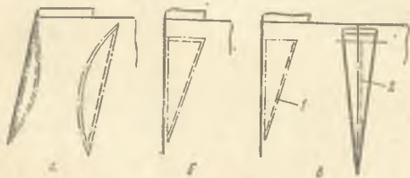
Рис. 11.5. Обработка вытачек-складок (защипов) и вытачек, переходящих в односторонние и встречные мягкие складки
