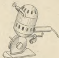
Рис. III.10. Передвижная раскройная машина с дисковым ножом
