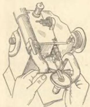
Рис. 1.87. Стачивающе-обметочная машина 10 Б кл. однониточного стежка
