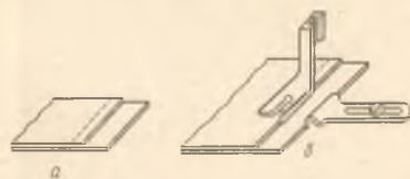
Рис. 1.75. Стачивающие строчки настрочного и запошивочного швов, линейка и лапка для их выполнения
