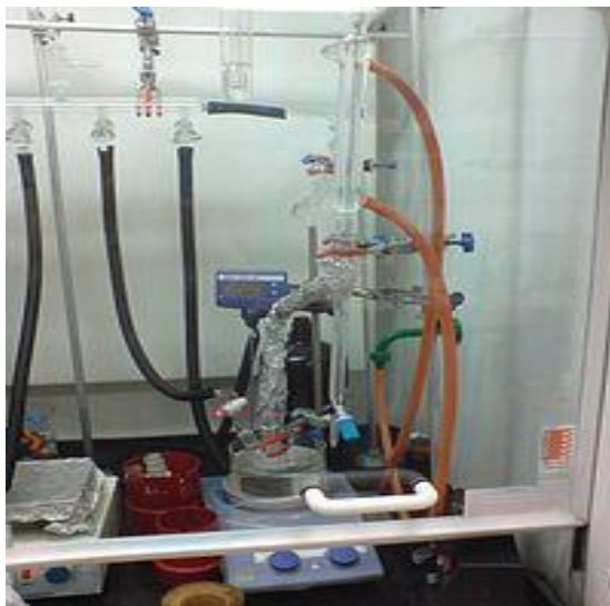
Eterifikatsiya reaksiyasida qo'llaniladigan Din-Stark apparati
