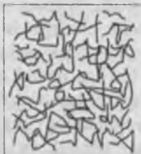
68-rasm. Makromolekulalarning suyultirilgan (a) va konsentrlangan (b) eritmalarida o'zaro joylashish sxemasi.
