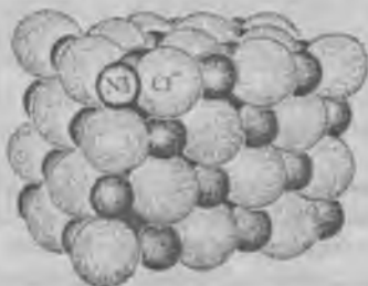
4.9-rasm. Natriy xlorid ( \text{NaCl} ) da ionlar joylashuvi.
