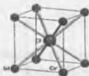
3.10- rasm. (a) CsCl strukturasini va (b) tekislikdagi tasviri
