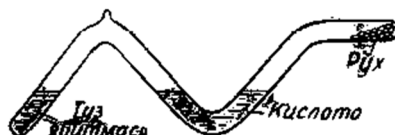
1- rasm. Bosim ostida vodorodning metallarni siqib chiqarish tajribalari uchun ishlatiladigan nay
