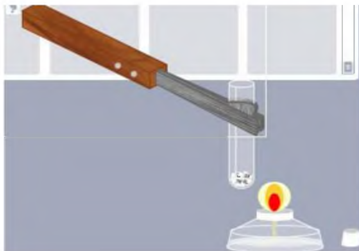
1.6-rasm. Laboratoriyada tajribalar olib borilayotganda probirkani quyidagicha ushlagichda ushlab qizdiriladi.
