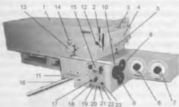
5.14-rasm. DFS-452 difraksiya spektrografning umumiy ko'rinishi:
