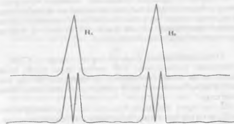
39-расм. ПМР спектрада сигналларнинг спин-спин таъсирида ажралиши.
