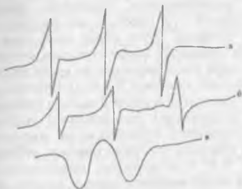
74-расм. Иминоксил радикаллари эритмаларининг ЭПР спектрлари: а-сувда, б-сувли глицеринда, в-сувли глицеринда ( -196^{\circ}\text{C} )
