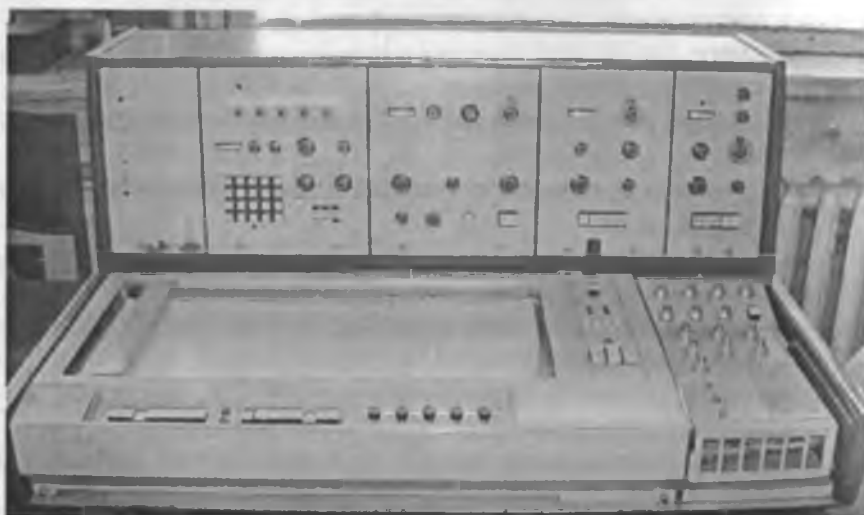
Расм 30. "Вариан" фирмасининг XL-100 ЯМР спектрометри (АҚШ)
