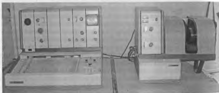
53-расм. Е-4 нусхали ЭПР спектрометрнинг (Вариан фирмаси, Германия) кўриниши.
