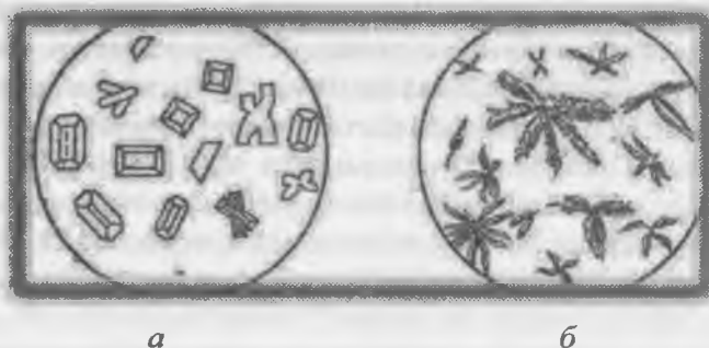
Рис. 2 Кристаллы MgNH_4PO_4 \cdot 6H_2O a — при медленной кристаллизации; б — при быстрой кристаллизации
