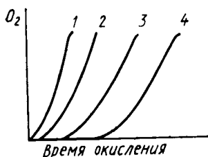
Рис. 18.9. Кинетические кривые окисления полипропилена при 140^\circ\text{C} в присутствии антиоксидантов (в эквимольных количествах): 1 — без антиоксиданта; 2 — бензидин; 3 — дифениламин; 4 — фенол- \beta -нафтиламин
