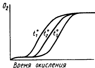
Рис. 18.3. Кинетические кривые окисления полимеров при трех разных температурах: t_1^{\circ} > t_2^{\circ} > t_3^{\circ}
