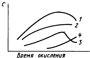
Рис. 18.4. Кинетические кривые образования кислородсодержащих функциональных групп (с, %) в процессе окисления углеводородного ненасыщенного полимера (полиизопрен) при 80°C ( t — время, ч): 1 — кетонные; 2 — гидроксильные; 3 — гидропероксидные; 4 — пероксидные
