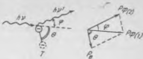
2.8- расм. Комптон эффектини тушунтириш схемаси.
