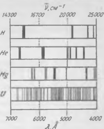
2.4-расм. Баъзи элементларнинг спектрларининг схемаси. (Спектрларнинг нисбий интенсивлигини кўрсатиш учун расмда чизик қалинликлари ҳар хил ўлчамда кўрсатилган. Ҳақиқатда эса ҳамма чизиклар бир хил қалинликка эга. Чизикларни бир-бирлари билан аралаштириб юбормаслик учун энг характерли чизиклар тасвирланган).
